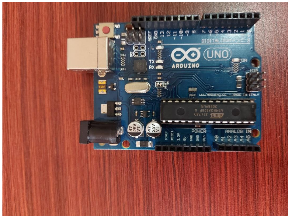
Gambar 3.10 Arduino Uno Sebelum Pemasangan Sensor Suhu
